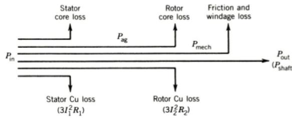
Figura 49: Fluxo de potência no motor de indução.
