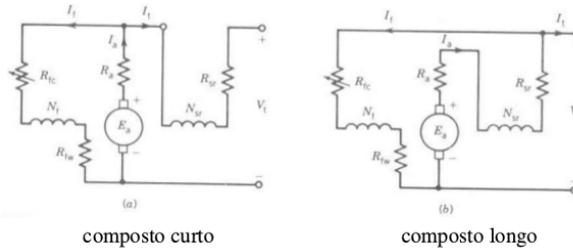
Figura 21: Circuitos do gerador CC com excitação composta.
