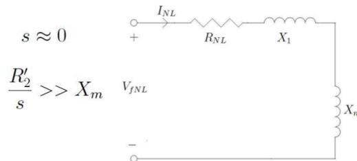
Figura 44: Circuito equivalente do ensaio em vazio.
