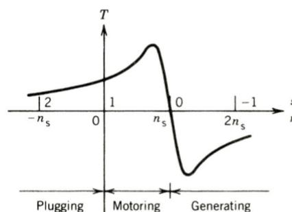
Figura 35: Modos de operação da máquina de indução.
