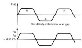
Figura 3: Tensão induzida na espira com anéis contínuos.
