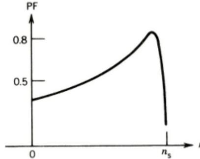
Figura 48: Variação do fator de potência com a velocidade  $n$ .
