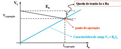
Figura 9: Ponto de operação do gerador CC.
