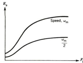
Figura 6: Curva de saturação da máquina CC.
