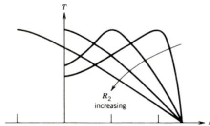
Figura 47: Característica torque-velocidade para diferentes valores de  $R_2$ .
