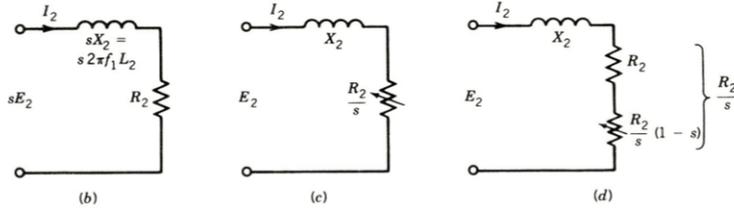
Figura 37: Circuitos equivalentes para o rotor.
