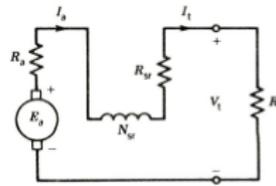
Figura 19: Circuito do gerador CC com excitação série.
