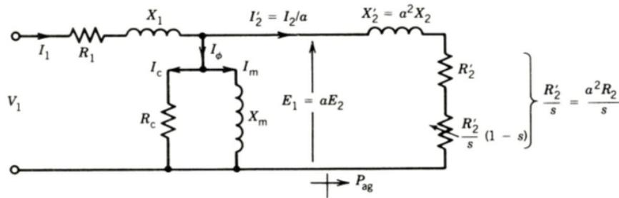
Figura 38: Circuitos equivalente completo para máquina de indução.
