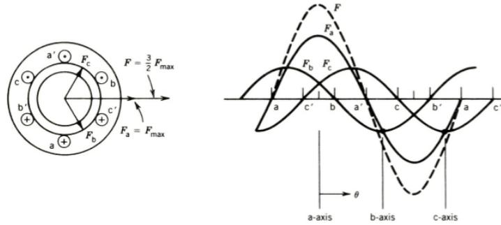
Figura 34: Campo girante na máquina de indução.
