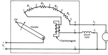
Figura 32: Dispositivo de proteção e partida (DPP).
