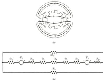
Figura 5: Circuito magnético equivalente da máquina CC.
