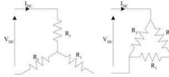
Figura 43: Resistência CC para ligação delta e estrela.
