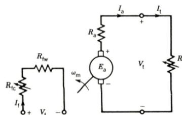
Figura 8: Circuito do gerador CC com excitação independente.
