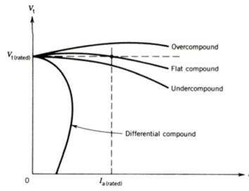
Figura 22: Curvas de regulação de tensão para excitação composta.
