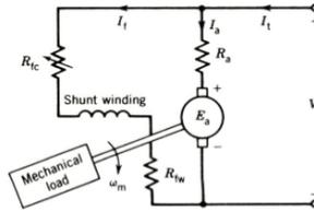
Figura 24: Circuito do motor CC de excitação paralela.
