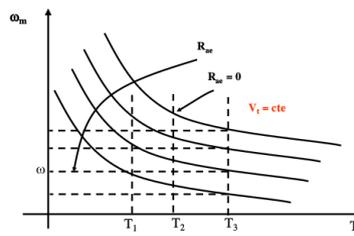
Figura 30: Característica torque-velocidade de um motor série.
