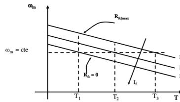
Figura 28: Controle via resistência de armadura  $R_a$ .
