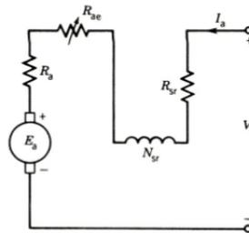
Figura 29: Circuito do motor CC com excitação série.
