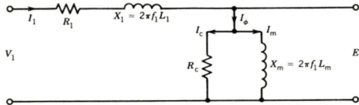
Figura 36: Circuito equivalente do estator.
