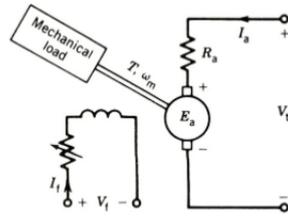
Figura 23: Circuito do motor CC de excitação independente.
