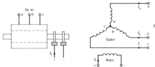
Figura 53: Estrutura básica de uma máquina síncrona.
