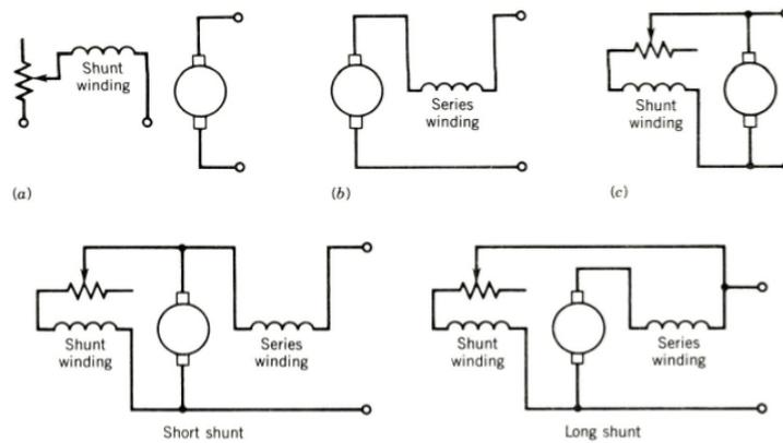
Figura 7: Diferentes formas de ligação das máquinas CC.
