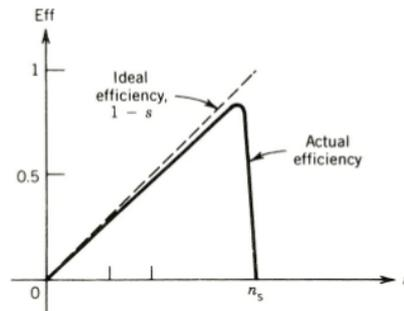
Figura 50: Eficiência como função da velocidade  $n$ .
