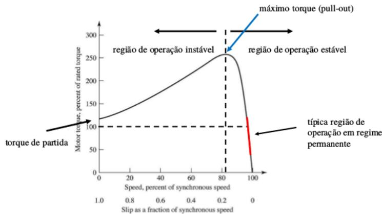
Figura 51: Região de operação da máquina de indução.
