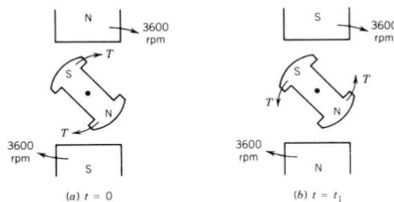
Figura 59: Torque no rotor da motor síncrono.
