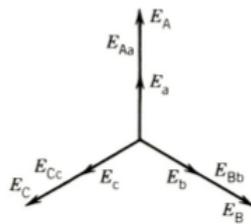
2. *Frequências diferentes, tensões e sequência de fase iguais* - os dois conjuntos de fasores giram a diferentes velocidades. Em  $t = t_1$ , a tensão nas lâmpadas é zero. Em  $t = t_2$ , as lâmpadas têm mesma intensidade. As lâmpadas vão acender e apagar alternadamente. Deve-se ajustar a velocidade da máquina e  $I_f$  para manter as tensões iguais.
