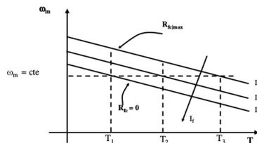
Figura 27: Controle via corrente de campo  $I_f$ .
