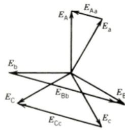
3. *Sequência de fase diferente, tensões e frequência iguais* - as tensões nas lâmpadas serão diferentes e elas terão brilhos diferentes. Para ajustar a sequência de fase, troca-se a conexão de dois terminais.
