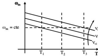
Figura 26: Controle via tensão terminal  $V_t$ .
