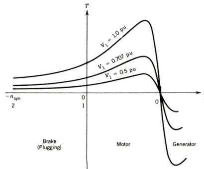
Figura 46: Característica torque-velocidade para máquina de indução.
