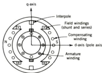
Figura 2: Diagrama da máquina DC com 2 pólos.
